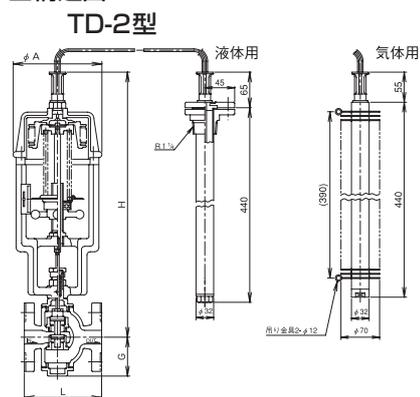
注. 呼び径により構造が多少異なります。TD-2L型、TD-2AL型はペローズ部の構造が多少異なります。
