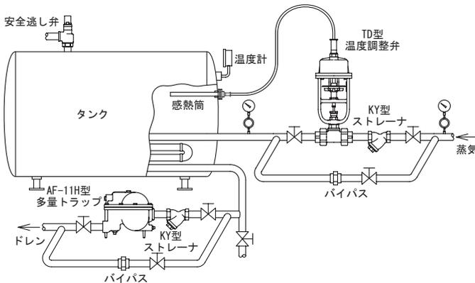
注. タンク側には必ず安全逃し弁を取り付けてください。
